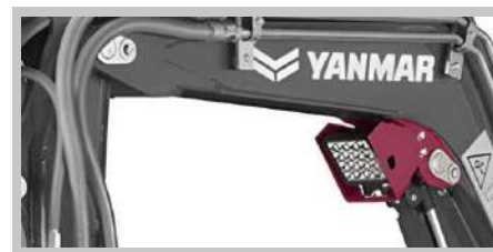
Foco led empotrado a la estructura y mangueras protegidas con resorte metálico
